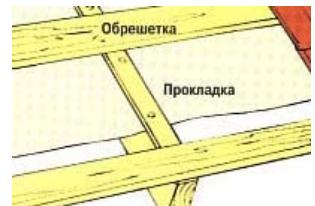
Гидроизоляционный материал предотвращает попадание влаги кровельного покрытия в связи с
