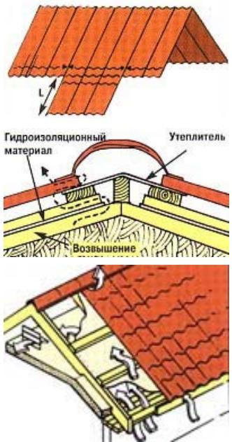
Гидроизоляционный ковер укладывают внахлест от карниза к коньку, при этом под коньком, должен быть зазор не менее 50 мм для беспрепятственного испарения влаги (если чердачное помещение теплое). Обрешетка должна быть выполнена так, чтобы воздух беспрепятственно проникал от карниза под конек крыши.
